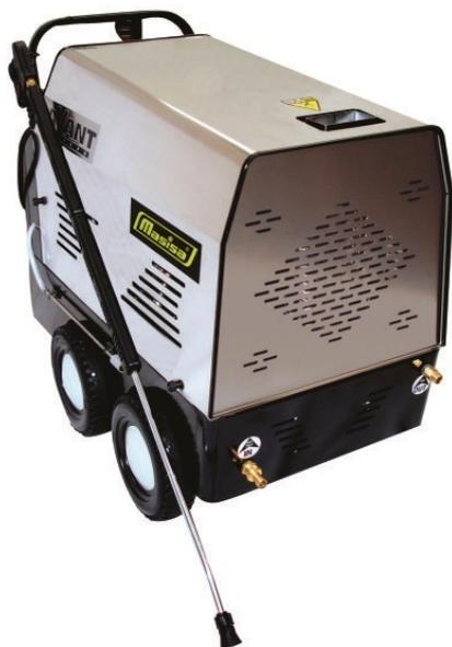
>>Hidrolavadora de agua caliente con motor eléctrico de 7.5 HP con capacidad de 220-240 VCA para trabajos pesados
