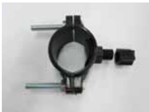
Retire los tornillos y las tuercas de tal forma que la abrazadera quede completamente desensamblada. Tome la parte del abrazadera que cuenta con una conexión roscada y colóquela en el tubo de drenaje de manera que el orificio recién perforado y el orificio de la abrazadera queden en línea. Tome la otra parte de la abrazadera, colóquela al lado contrario del tubo y proceda a unirla con sus tornillos y tuercas. Apriete.
