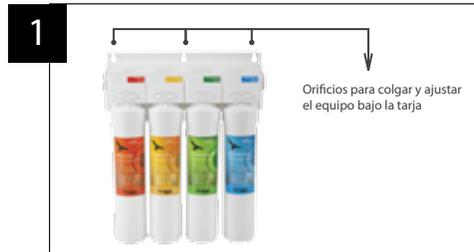
Marque en la pared elegida bajo la tarja, los puntos en los que deberán perforarse 3 agujeros. Utilizando un taladro eléctrico con una broca de 1/4", perforo los agujeros. Inserte en cada uno de ellos taquetes plásticos o de madera de 1/4" de diámetro y colque 3 pijas de 1/8" x 1 - 1 1/2" de largo, procurando que la cabeza de la pija, quede un poco de fuera para que pueda recibir el equipo.
