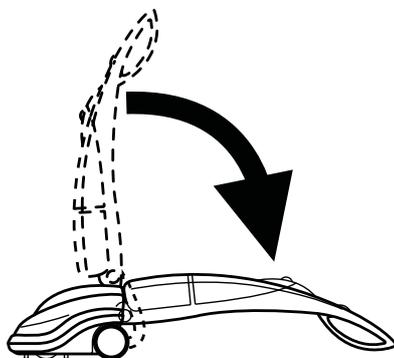
Altura mínima de trabajo 200 mm.: permite limpiar debajo de muebles, sillas, mesas, camas, etc. El mango reclinable garantiza el uso diario fácil y sencillo de la maquina. La gran capacidad de los tanques evita paradas frecuentes para llenar la unidad.
