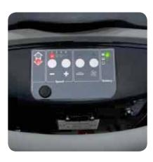
Panel de control analógico, fácil e intuitivo. Regulador velocidad de avance. Interruptor general de llave, interruptor motor cepillo y motor de aspiración. Disyuntor térmico para proteger motor cepillo y motor de aspiracion, indicador de nivel de batería, contador de horas de trabajo
