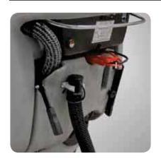
Palanca de transmisión del cepillo y distribución de la solución detergente. Manguera de vaciado del déposito agua de recuperacion con caudal regulable. Acoplamiento rápido para la carga de baterías.
