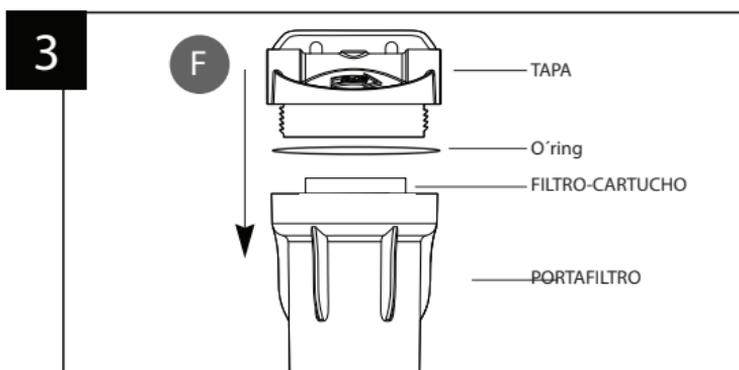
(F) Una vez realizadas estas conexiones, quite la envoltura del filtro cartucho y colóquelo en el vaso del Porta-filtro. Asegurarse que el O'ring este posicionado en la ranura del vaso antes de instalarlo en la tapa.
