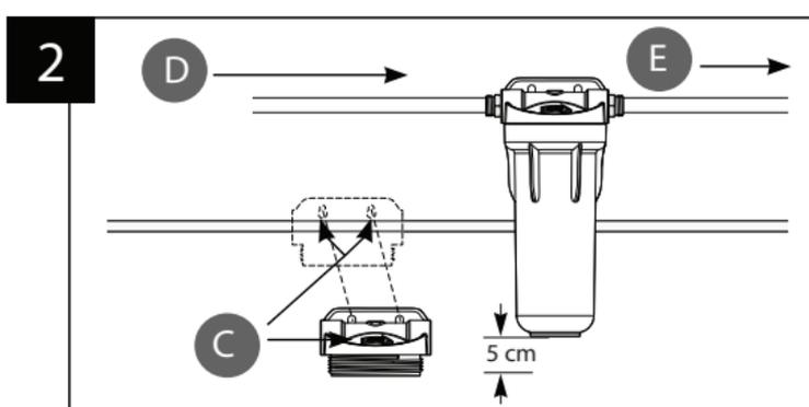
(C) Quitar la tapa del Porta-filtro para que pueda fijarla a la pared donde requiere instalarlo (es importante verificar la orientación de flujo marcada en la tapa).
