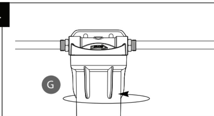
(G) Colocar el vaso del Porta-filtro en la tapa y gírelo con la mano hacia la derecha. Utilice la llave incluida en el Porta-filtro solamente para apretar un poco y asegurar el cierre hermético del Porta-filtro.
