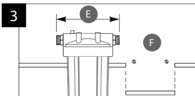
(E) Mida las distancias entre las conexiones roscadas y reste 1 cm por cada lado para tener la medida del segmento de tubo que va a cortar.
