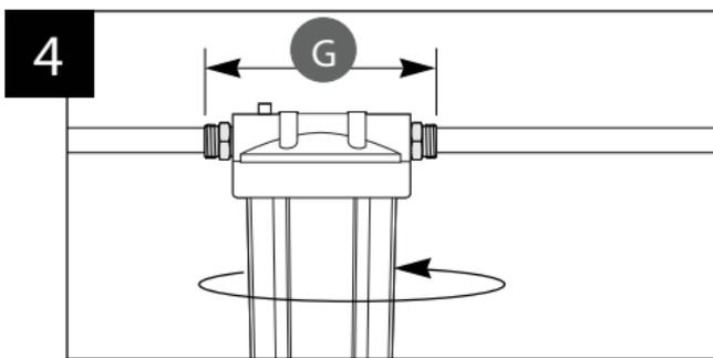
(G) Introducir la tubería en cada extremo del Porta-filtro. Asegurese que este correctamente conectado. Colocar el vaso del Porta-filtro en la tapa y gírelo con la mano hacia la derecha. Utilice la llave incluida en el Porta-filtro solamente para apretar un poco y asegurar el cierre hermético del Porta-filtro.
